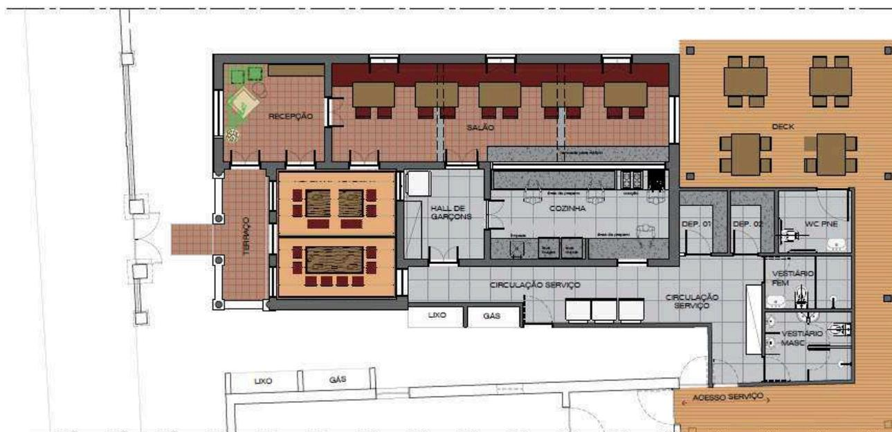
Figura 4: Planta de layout da proposta.
